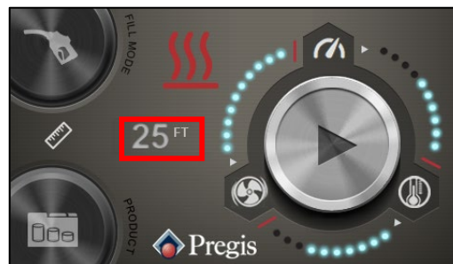
Bild 20. Både längd och tid per körning kan justeras genom att välja symbolen Körtid/längd.
