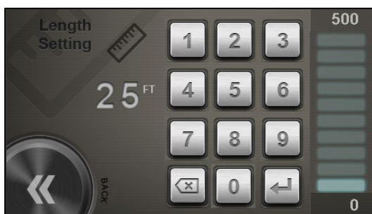
Bild 21. Längd-läget används för att välja inställningen för kuddlängd. Start-knappen måste vara intryckt.
