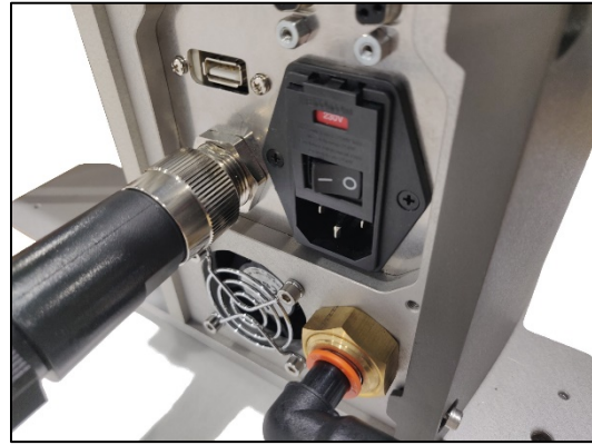
Bild 7. Ansluta luftpumpen till maskinens baksida.
